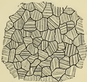
Fig. 13. Dünnschliff von Marmor in mehrfacher Vergrößerung, um die Zwillinglamellen von Calcit zu zeigen.
